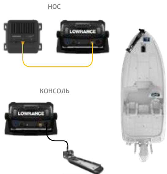
Между двумя приборами БЕЗ СЕТИ
